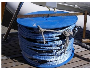
En rulle med 100 m 8 mm draglina med 116 påsydda koner.
